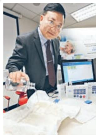
特製尿片、感應器及顯示器。照顧者將感應器夾在特製尿片，便可檢測尿濕狀況，分為大、中、小3個程度，顯示器會顯示是否需要更換尿片。
